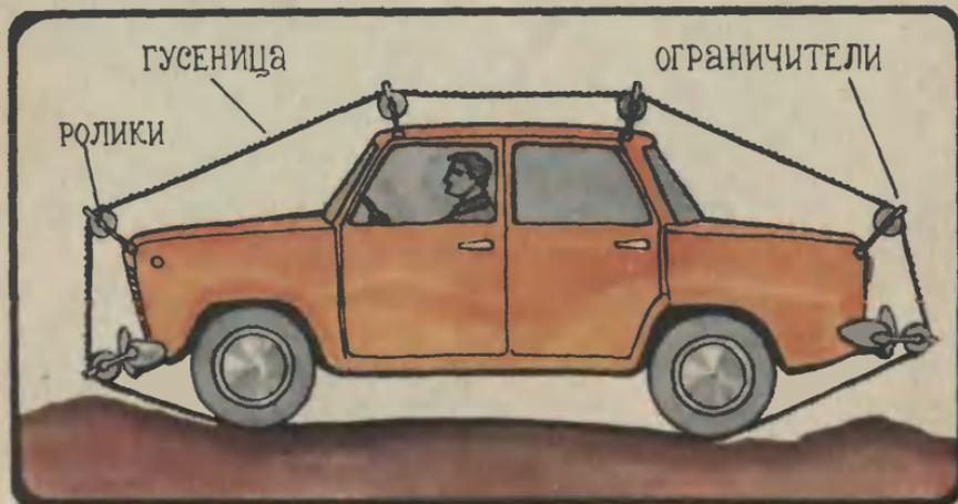
катки крепятся на переднем и заднем бамперах. Сама лентогусеница делается из армированной синтетической резины. Ограничительные реборды на роликах не дают ей съезжать вбок.
